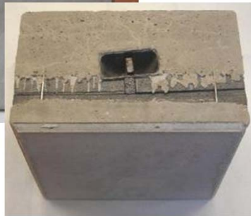
Pannello a Taglio Termico 50x50x30 cm sottoposto a 200 cicli di Gelo/Disgelo
