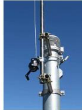
Sistema di sollevamento e posizionamento del rotore VAWT.
