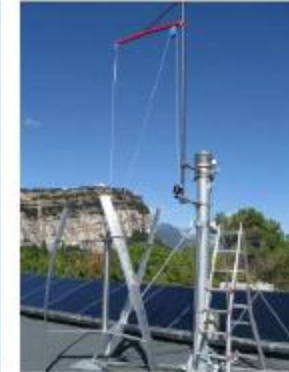
Sistema di sollevamento e posizionamento del rotore VAWT.
